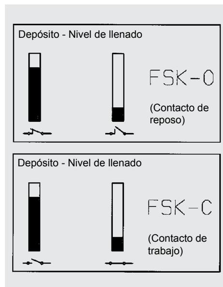
El esquema lógico del control de nivel de fluido se tiene en cuenta respectivamente desde el depósito lleno.
