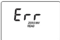
**ZERO INV/READ (Vertauschte Küvetten):** Proben- und Blindprobenküvette sind vertauscht.
