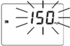
**Messwert oberhalb des Messbereiches:** ein blinkender Wert der maximalen Konzentration zeigt an, dass der Messbereich überschritten wurde. Die Probenkonzentration liegt über dem programmierten Bereich: verdünnen Sie die Probe und führen Sie die Messung erneut durch.
