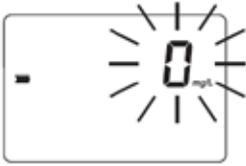
**Messwert zu niedrig:** die blinkende Anzeige "0.000" weist darauf hin, dass die Probe weniger Licht als die Blindprobe absorbiert. Überprüfen Sie den Vorgang und stellen Sie sicher, dass für Nullabgleich und Messung ein- und dieselbe Küvette verwendet wird.
