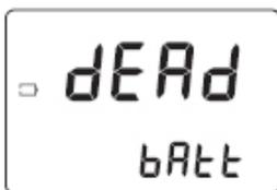
**Dead battery:** Batterie leer. Dies zeigt an, dass die Batterie leer und ein Batterie erforderlich ist. Sobald diese Meldung erscheint, blockiert das Gerät. Wechseln Sie die Batterie und schalten Sie das Gerät wieder ein.
