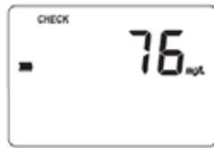
Erscheint ein anderer Wert ausserhalb des Toleranzbereiches, prüfen Sie die Küvette auf Verschmutzungen (Fingerabdrücke). Ansonsten wird empfohlen, das Photometer zu kalibrieren.
